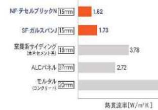
アイジーサイディングは断熱性に優れたポリイソシアヌレートフォームを採用し、他の外壁材と比較しても抜群の断熱性能を誇ります。高い断熱性で冷暖房費などの光熱費を削減でき、省エネルギーでCO2の削減に貢献します。
